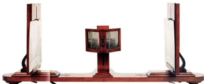
図116 チャールズ・ホイートストーンの「ステレオスコープ」
